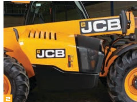
Am Ausleger haben wir uns für ein robustes U-Profil mit vollverschweißtem Abschlussblech entschieden. Für noch mehr Stabilität haben wir die Anzahl der Verbindungs- und Belastungspunkte am integrierten Auslegerkopf sowie an der einteiligen Abschlussplatte weitestgehend reduziert.
