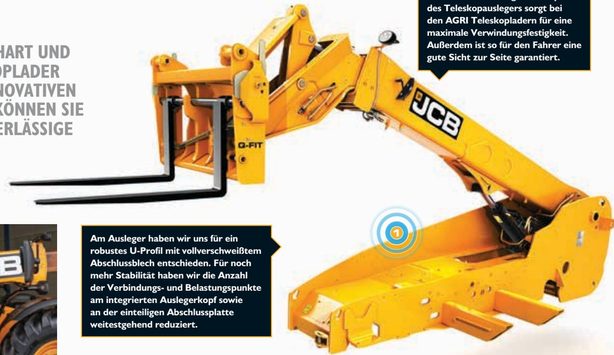
Das einteilige, vollverschweißte Fahrgestell sorgt für maximale Belastbarkeit bei minimalem Gewicht. Der niedrige Anlenkpunkt des Teleskopauslegers sorgt bei den AGRI Teleskopladern für eine maximale Verwindungsfestigkeit. Außerdem ist so für den Fahrer eine gute Sicht zur Seite garantiert.
