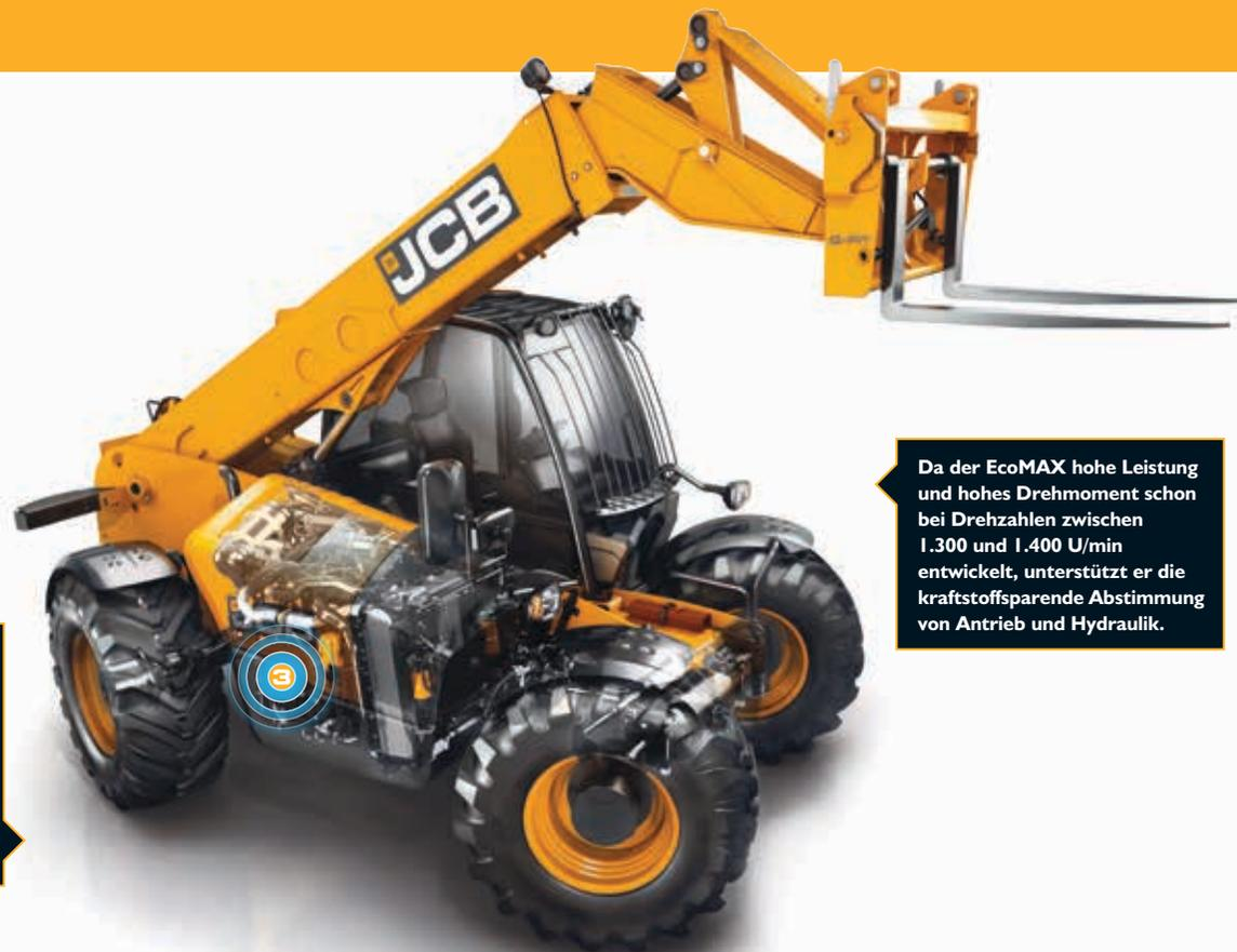
Da der EcoMAX hohe Leistung und hohes Drehmoment schon bei Drehzahlen zwischen 1.300 und 1.400 U/min entwickelt, unterstützt er die kraftstoffsparende Abstimmung von Antrieb und Hydraulik.
