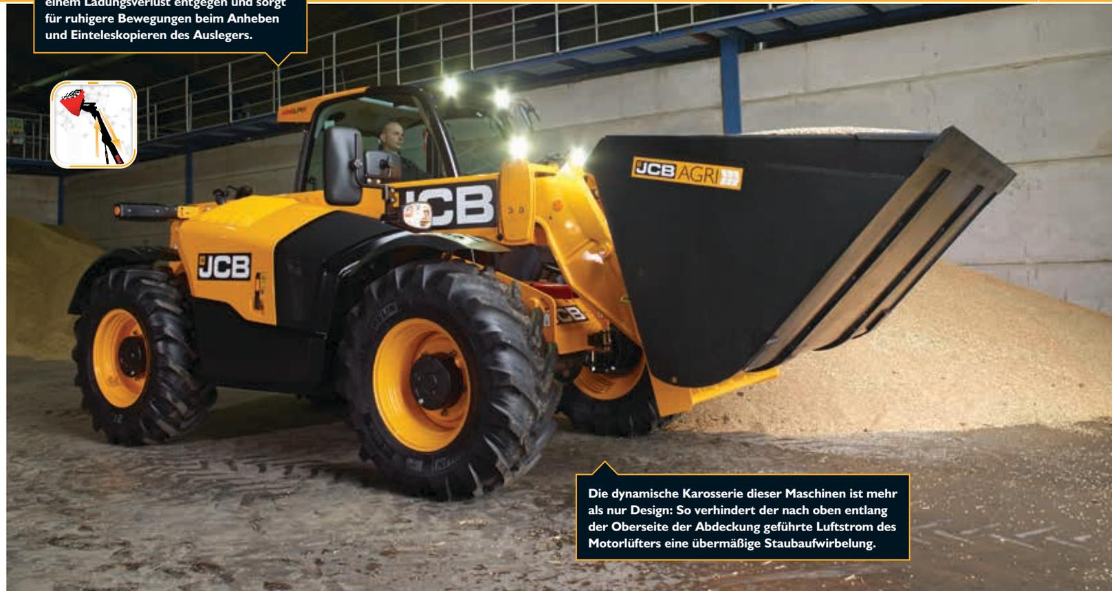
Die dynamische Karosserie dieser Maschinen ist mehr als nur Design: So verhindert der nach oben entlang der Oberseite der Abdeckung geführte Luftstrom des Motorlüfters eine übermäßige Staubaufwirbelung.
