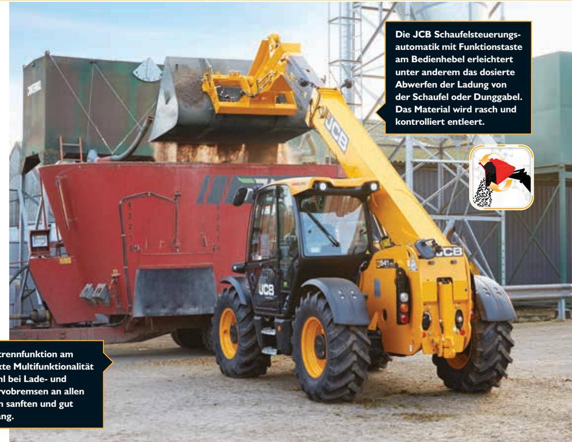
Die JCB Schaufelsteuerungsautomatik mit Funktionstaste am Bedienhebel erleichtert unter anderem das dosierte Abwerfen der Ladung von der Schaufel oder Dunggabel. Das Material wird rasch und kontrolliert entleert.
