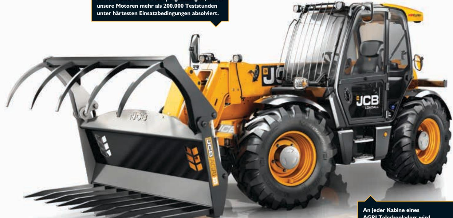
An jeder Kabine eines AGRI Teleskopladers wird vor der Lackierung zum Langzeitschutz vor Korrosion das Schmelztauchverfahren angewandt.
